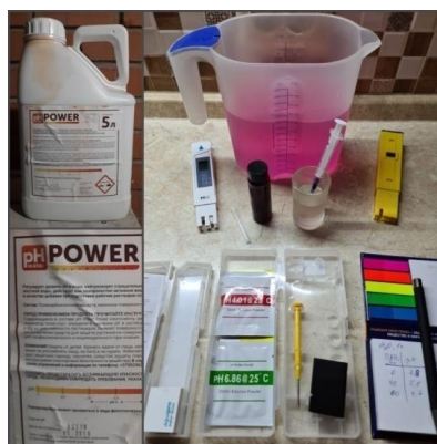
Рисунок 3 – Тестирование технической воды на уровни pH
