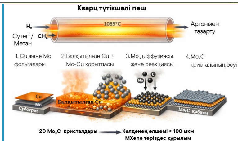
Сурет 10. Химиялық бу фазасында тұндыру әдісінің сызбанұсқасы
