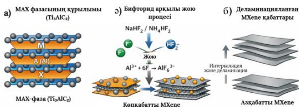
Сурет 8. Бифторид тұздарымен өңдеу әдісіні арқылы МХене алу сызбанұсқасы
