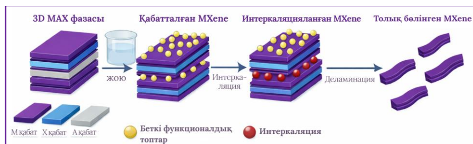
Сурет 4. MXene синтезі үшін жоғарыдан төмен қарай әдісінің сызбалық көрнісі
