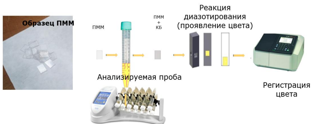
Рисунок 2. Схема колориметрического определения карбарила по 1-нафтолу с использованием ПММ
