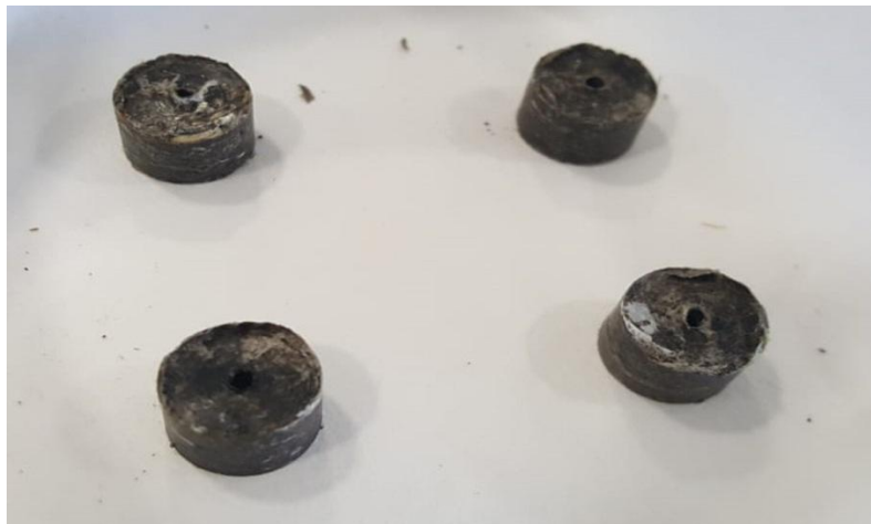
Сурет 1. Қысыммен престелген үлгілер
