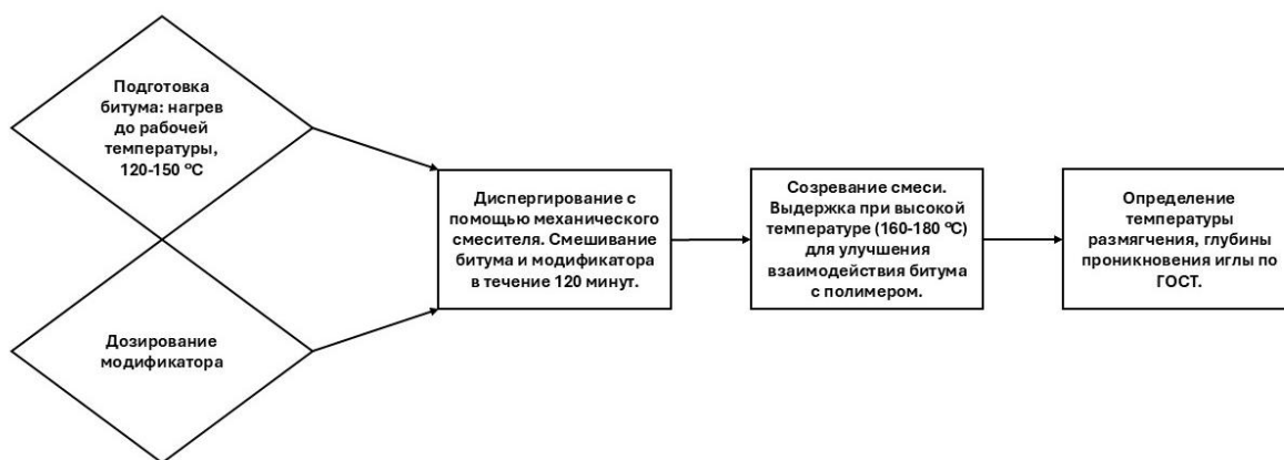
Рисунок 4. Схема процесса получения полимерно-модифицированного битума с использованием полимерных отходов
