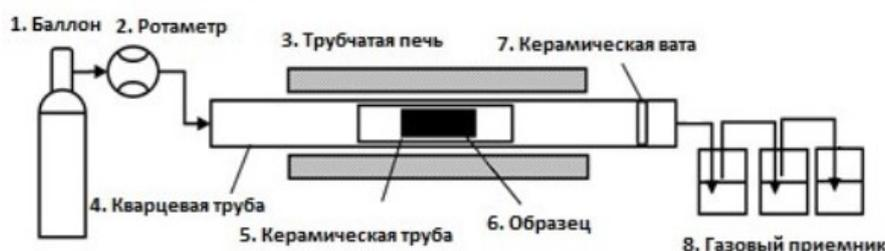
Рисунок 1 – Горизонтальный кварцевый трубчатый реактор [6]
